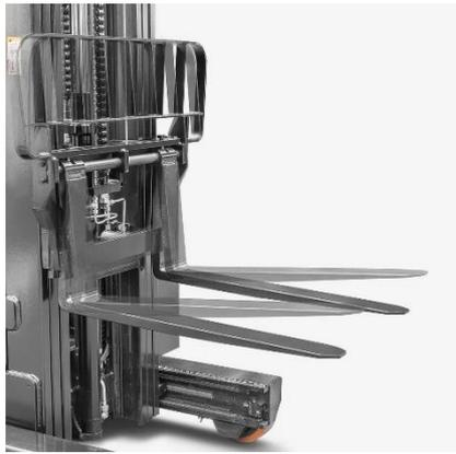
➔ LAS HORQUILLAS SE PUEDEN INCLINAR HACIA DELANTE O HACIA ATRÁS PARA FACILITAR LA CARGA
