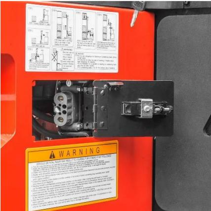
➔ ENCHUFE DE CARGA DENTRO DEL COMPARTIMIENTO DEL OPERADOR, ESTO ELIMINA LA NECESIDAD DE DESCONECTAR EL ENCHUFE DE LA BATERIA, MEJORANDO LA FACILIDAD DE OPERACIÓN (STD)
