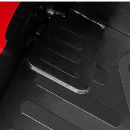
➔ PEDAL DE SEGURIDAD: AL SOLTAR EL PEDAL, SE DETIENE EL DESPLAZAMIENTO Y SOLO SE HABILITA EL FUNCIONAMIENTO HIDRAULICO
